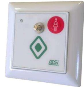
Bestehend aus MFV-Wahlgeber integriert in der Anschlussdose mit Beruhigungs-LED, Identifikation über RFID Tag, sowie den Anschlusspunkten für Empfangseinheit, Funkfingerempfangseinheit, Zugtaster, Flursignallampe, Metallhalterung für RFID Tag, Telefon a/b und Stromversorgung.
