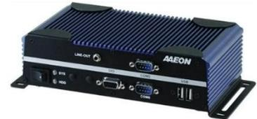
Verwendung eines Intel® Pentium® N3710 Prozessors, mit einer Taktgeschwindigkeit von bis zu 1,6 GHz und mit minimalem Stromverbrauch.
